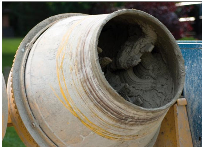
Grind, zand, cement en water worden in een betonmolen gemengd tot metselspecie of betonspecie.
