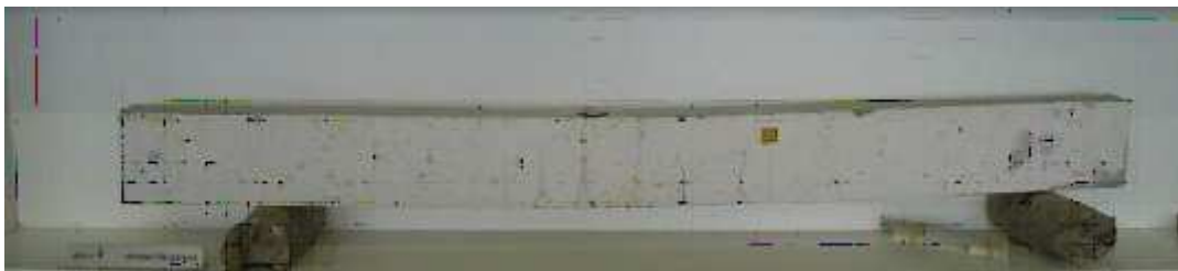
Afbeelding 2: Beton heeft een zeer lage buigsterkte. Ondanks deze nadelen blijft beton een geliefd bouwmetaal.
