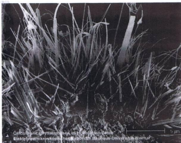
Figuur 4.2: Vezels van \text{C}_s\text{H} , opgenomen met een elektronenmicroscop (bron Beton technologie voor Onderwijs & Praktijk, publicatie van de Betonvereniging en het Cement & Beton Centrum i.o.)
