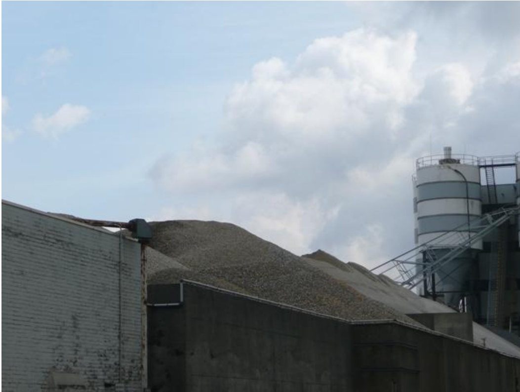
Figuur 3.1: Zand en grind liggen klaar om met cement en water in de 'molen' gemengd te worden.
